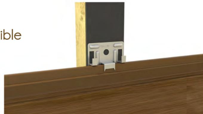
La instalación del revestimiento GEO CLASSIC se realiza mediante grapas invisibles de acero inoxidable sobre un lecho de listones de madera o aluminio. De este modo, las lamas encajan entre sí conservando una holgura de 2 mm entre el soporte y la lama para permitir la ventilación de los rastreles.
